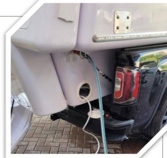
einfaches Befüllen der Wassertanks über einen gängigen Gartenschlauch
