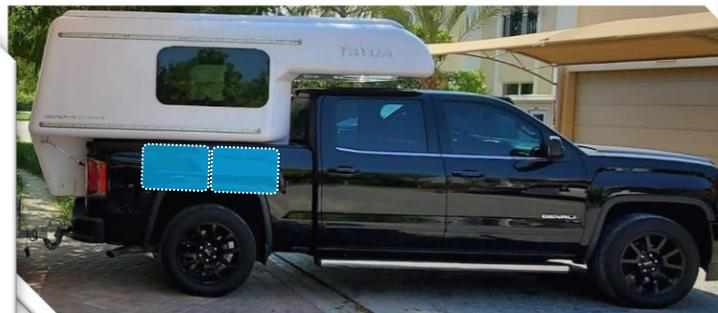
Die Wassertanks an der optimalen Position direkt über der Hinterachse
