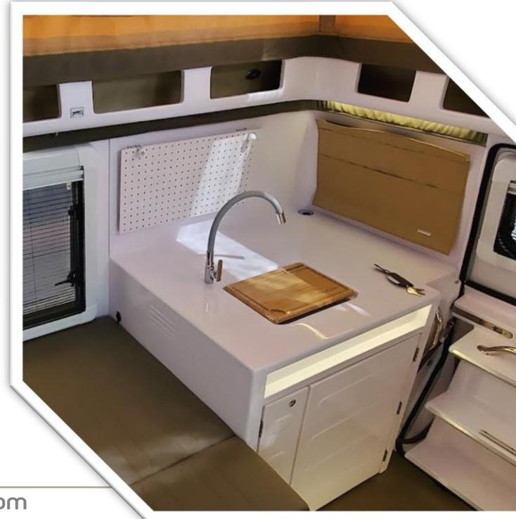
Das passgenaue Schneidebrett für das Spülbecken wird bei Nichtgebrauch reisesicher hinter der Lochplatte verstaut.
