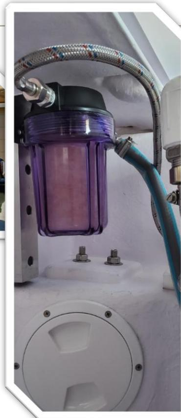
Wasserfilter mit Filterkartusche
