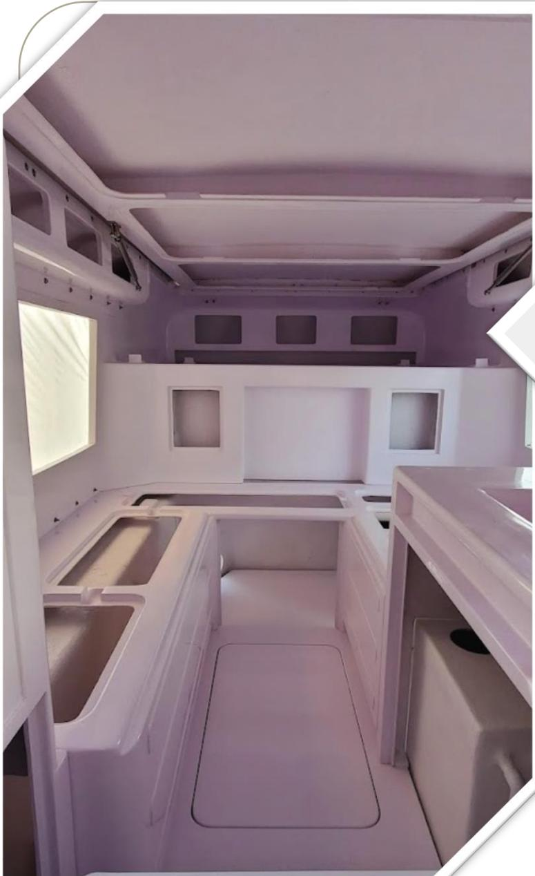
Die Fiberglasleerkabine ab Werk. Mit Ausnahme der Eingangstüren und das Dach, sind alle Fiberglasteile nicht installiert, werden jedoch beigelegt.
